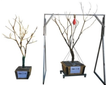
图 4 移植木箱及吊装模型
